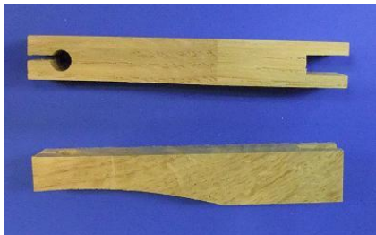
7. Ärmchen für Pedalwinkel Eiche, 90 x 15 x 12
